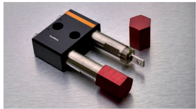
Système de fracturation de verrière : boîtier de commande (1/4).
