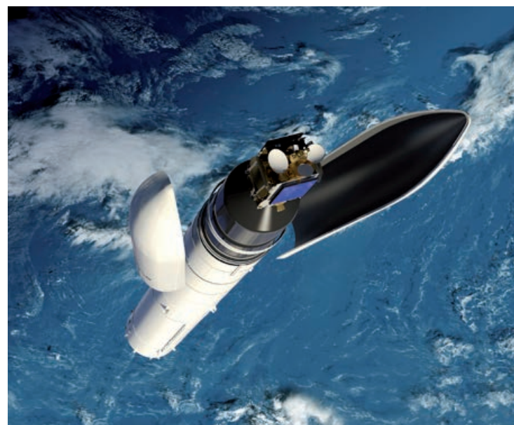
Ouverture de coiffe et libération d'un satellite sur Ariane 6.
