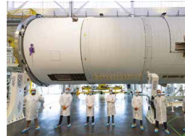
Flüssigsauerstofftank der Ariane 6 für kombinierte Tests (Les Mureaux)
