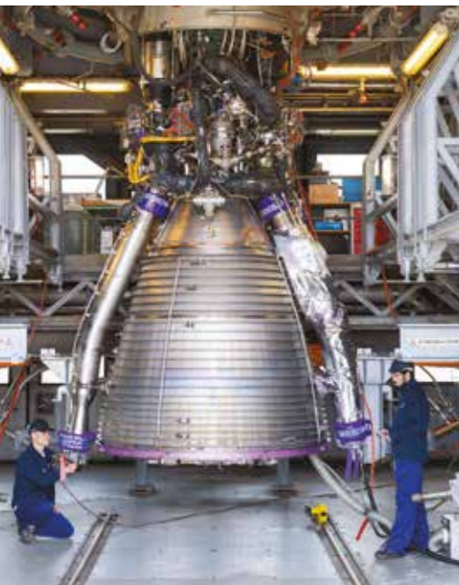
Ariane 6 Vulcain 2.1 Triebwerkstestvorbereitung (Vernon)
