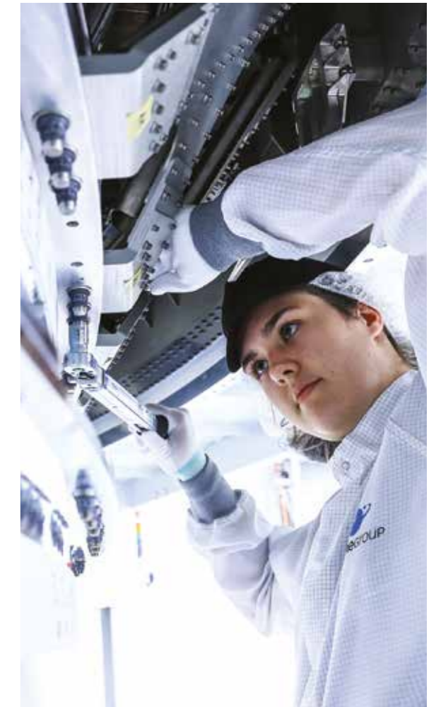
Montage der Oberstufe der Ariane 6 (Bremen)
