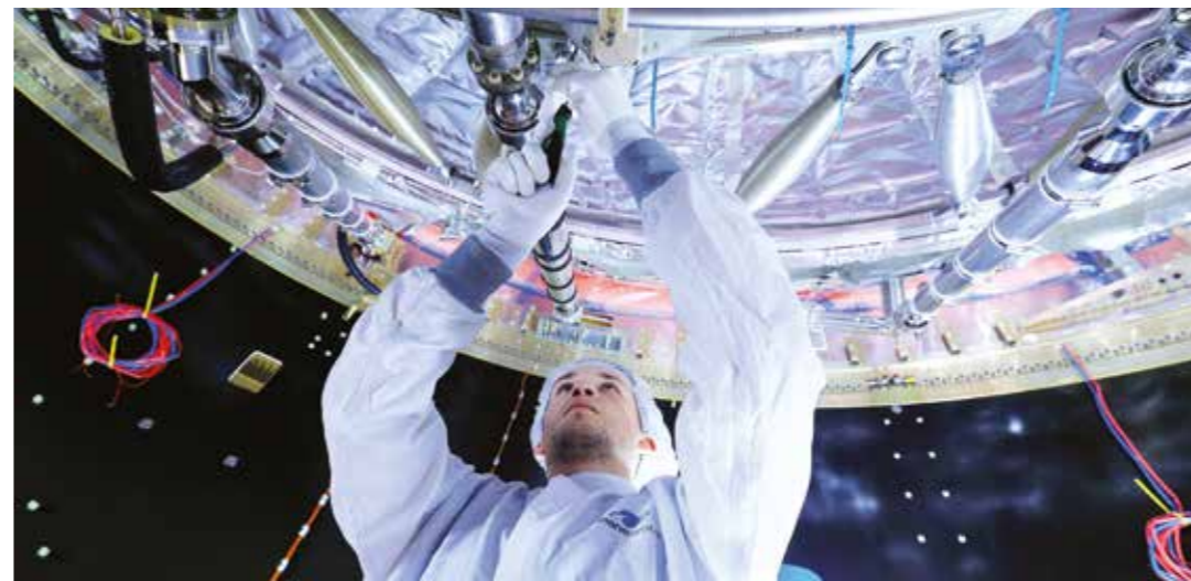
Integration der Oberstufe der Ariane 5 (Bremen)
