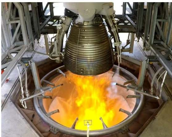
Test de qualification du moteur Vulcain 2.1 sur le banc de test P5 sur le site du DLR à Lampoldshausen (Allemagne)
