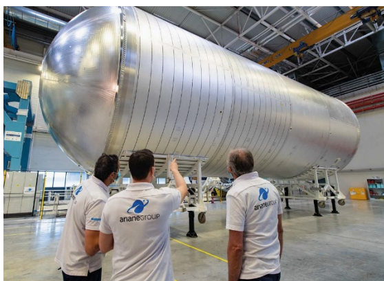
Réservoir d'hydrogène pour le programme Ariane 6 aux Mureaux (France)
