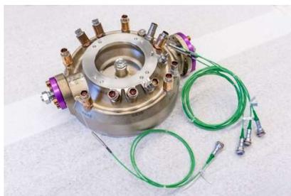
La configuration d'essai actuelle intègre la première tête d'injection de chambre de combustion imprimée 3D à taille réelle d'ArianeGroup destinée aux chambres de combustion de prochaine génération. Elle vient d'effectuer avec succès des premiers essais de mise à feu dans des conditions représentatives au banc d'essai P3.2 de l'Agence aérospatiale allemande (DLR) à Lampoldshausen. Utilisant les acquis des activités antérieures de R&T à échelle réduite, la tête
